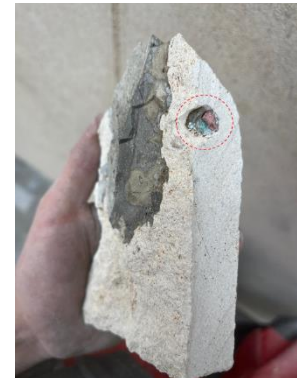
Photographie de la tige métallique insérée dans la pierre
