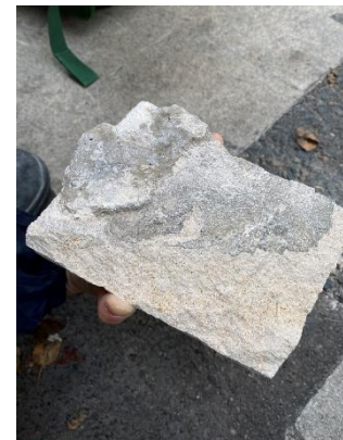
Vue de la colle à l'arrière de la pierre de parement
